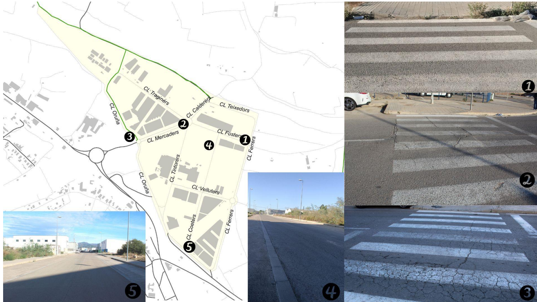
Imagen 10. Ausencia o desgaste de señalización horizontal
